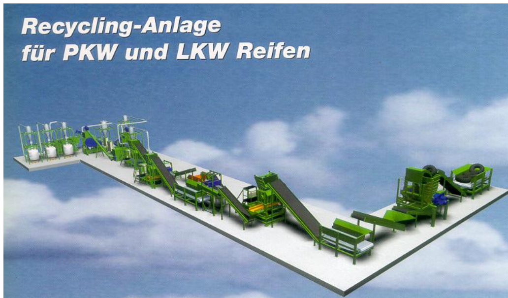
7.5.2.4.2. ábra. A MeWa Recycling Maschinen und Anlagebau (Freiberg, BRD) GmbH gumiörlőüzeme
