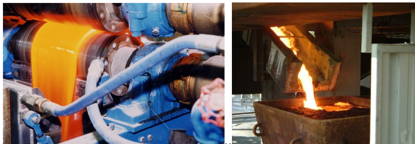
6.2.3.13. ábra. Az üvegtermék eltávolítása hengerpárral vagy csapolással történik
