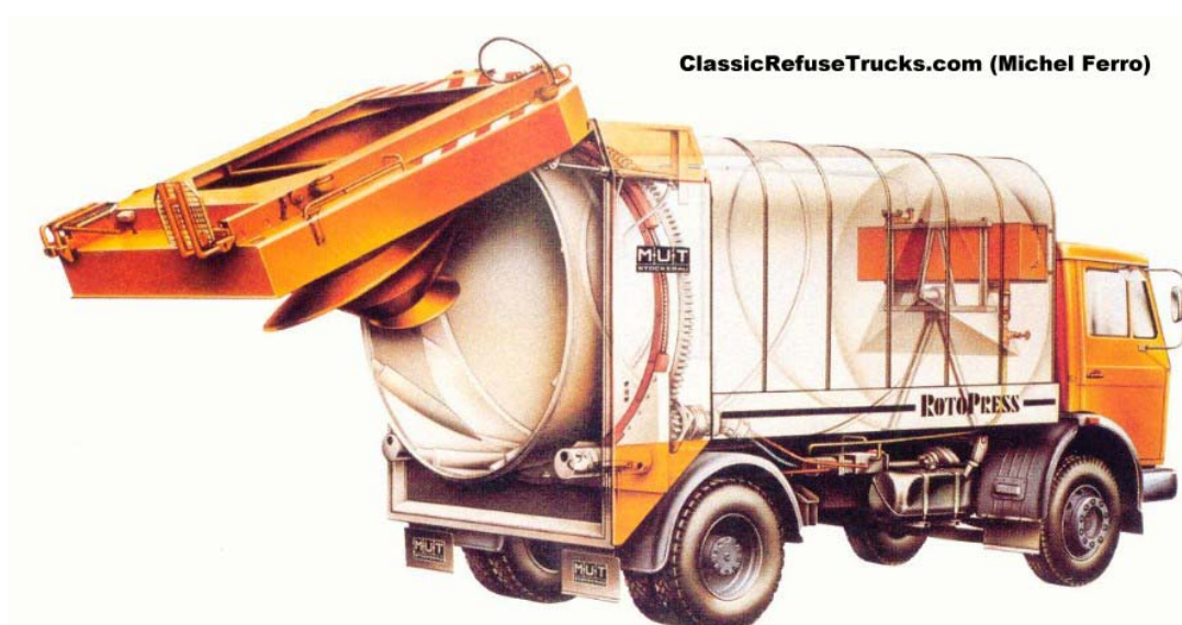
5.4. Ábra. A Rotopress típusú hulladék tömörítés elve.
